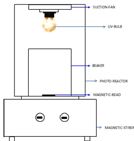
**Fig. 1:** Photoreactor
